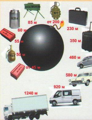
Рекомендуемые зоны (в метрах) эвакуации и оцепления при обнаружении взрывного устройства или подозрительного предмета
